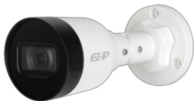
IP камера Dahua EZ-IPC-B1B20-0360B уличная цилиндрическая 2Мп, фикс. объектив 3.6мм, ИК до 30м, DC12В, PoE, IP67
