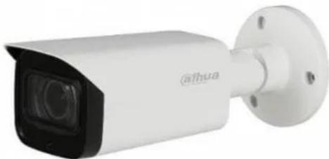
IP камера Dahua DH-IPC-HFW2231TP-ZS уличная 2Мп, мотор.объектив 2.7-13.5мм, WDR, MicroSD, ИК до 60м, DC12B/PoE, IP67, IK10
