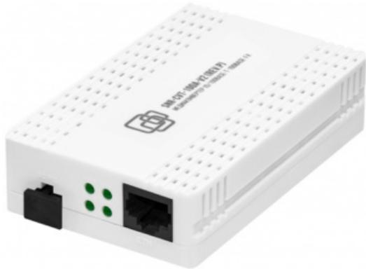
Медиаконвертер 100-Base-T/100Base-FX, Tx/Rx:
