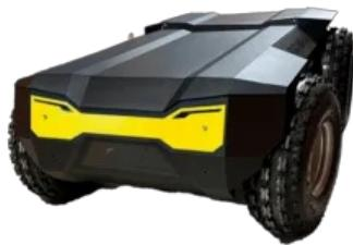
Ровер PIRANHA - всепогодная роботизированная платформа-вездеход для перевозки и патруля, груз 300 кг
