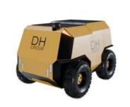
Ровер CARGO SHELL - роботизированная платформа с закрытым корпусом и мультиадресной доставкой грузов до 150 кг
