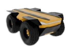
Ровер LEGAT - патрульная роботизированная платформа для видео-, газо- и термо-инспекции, полезная нагрузка 300 кг
