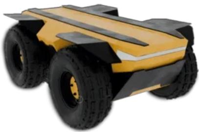
Ровер LEGAT - патрульная роботизированная платформа для видео-, газо- и термо-инспекции, полезная нагрузка 300 кг
