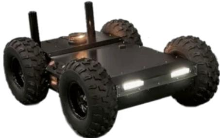
Ровер FRAME - базовая роботизированная платформа под интеграцию оборудования, грузоподъёмность 150 кг
