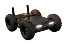
Ровер FRAME - базовая роботизированная платформа под интеграцию оборудования, грузоподъёмность 150 кг
