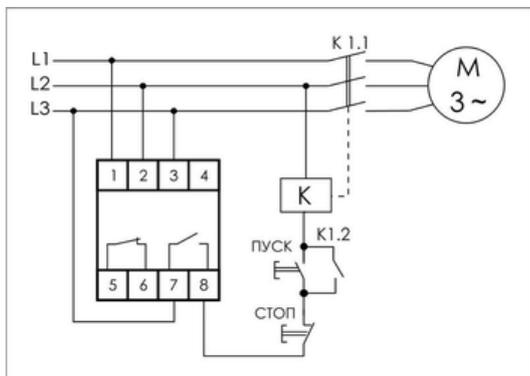
Реле контроля фаз для сетей с изолированной нейтралью СКФ-11 (монтаж на DIN-рейке 35мм; регулировка
