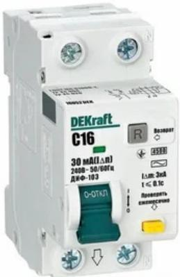
**Выключатель автоматический дифференциального тока 2п (1P+N) С 16А 30mA тип АС 4.5кА ДИФ-103 DEKraft**
