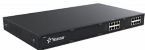
IP ATC Yeastar S100, 100 (до 200) абонентов и 30 (до 60) вызовов, PRI, MFC R2, SS7, поддержка FXO, FXS, GSM, BRI
