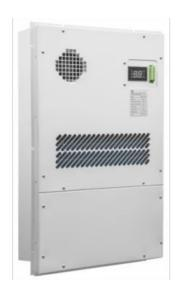
Кондиционер для установки в уличный шкаф, холодопроизводительность 1000Вт, со встроенным электрическим калорифером, 220В переменного тока
