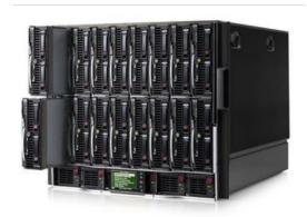
Шасси НР для блейд-системы c7000 G3, скомплектованное (6x PS, 2x Admin, 10x Fan, 1x Single Phase AC Input, 1x RailKit)
