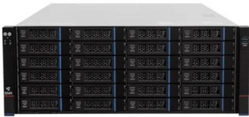
Серверная платформа SNR-SR4324RS, 4U, Scalable Gen3, DDR4, 24xHDD, резервируемый БП
