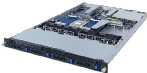
Платформа Gigabyte 1U R162-ZA0, \*Один процессор\* AMD EPYC 7003, DDR4, 4x3.5"/2.5" SATA/SAS, 2x1000Base-T
