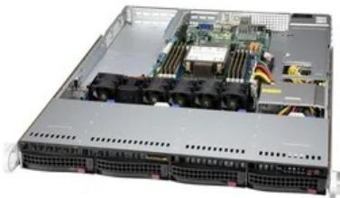
Платформа Supermicro 1U SYS-510P-WT, До одного процессора Intel Xeon Scalable, DDR4, 4x3,5" HDD SATA, 2x10GBase-T
