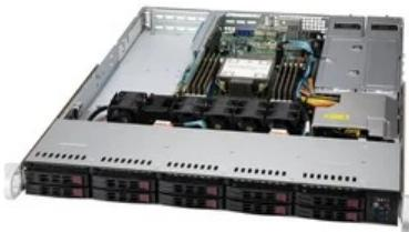
Платформа Supermicro 1U SYS-110P-WTR, До одного процессора Intel Xeon Scalable, DDR4, 10x2,5" HDD SATA, 2x10GBase-T
