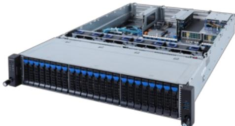
Платформа Gigabyte 2U R282-200, До двух процессоров Intel Xeon Scalable Gen3, DDR4, 24x2,5" HDD SATA/SAS, 2x1000Base-T
