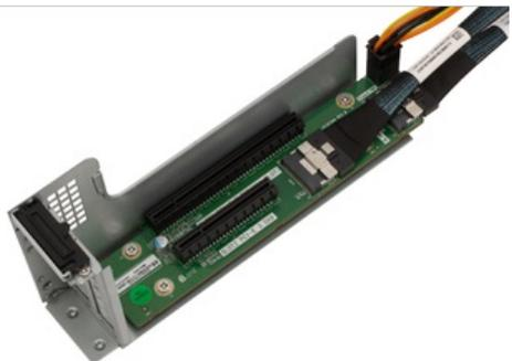
Адаптер 2x PCI-Ex8 для серверов SNR 2U, 4U серии RS/RE, slot 4 SNR-RM2112-PCIEIB4
