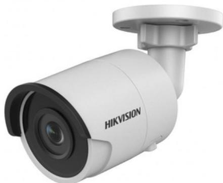
Уличная цилиндрическая IP-камера DS-2CD2023G0-I (2.8mm), 2Мп, 2.8мм, 12V/PoE, ИК-подсветка до 30м, microSD до 128Гб, WDR 120дБ
