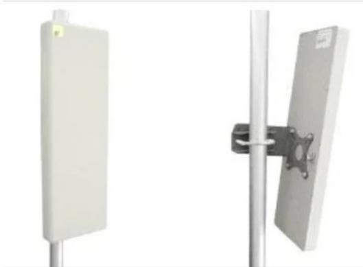
Сambium направленная антенна для базовой станции eRMP 1000, 9°x15°, 5.9-6.5ГГц, MIMO2x2, 23dBi с комплектом крепежа
