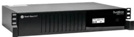
Источник бесперебойного питания Smart-Save SMT Systeme Electric 1000 ВА, монтаж в стойку 2U, 230 В, 6 розеток IEC C13, SmartSlot, AVR, LCD, USB HID
