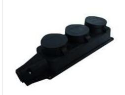
Колодка удлинителя 3-м с заземл. 16A IP44 1ф 250B еврослот с заглушками каучук UNIVersal 602230
