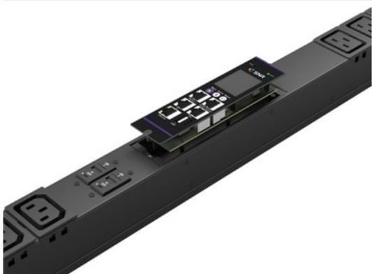
Блок розеток с функцией измерения и управления каждой розеткой серии SNR тип С на 21xC13 и 3xC19 с фиксаторами, шнур питания 3 м с IEC60309 32A 3P+N+E
