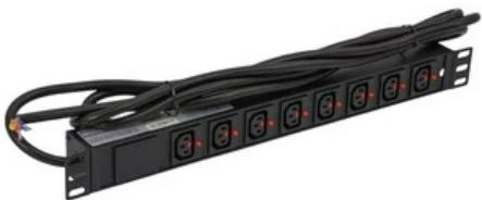
**Блок розеток серии SNR-PDU с локальным измерением на 8xC13 с фиксаторами, шнур питания 3м 3x2.5мм<sup>2</sup> без вилки, 230В, 16А**
