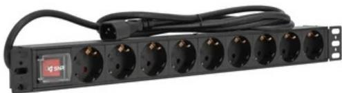
Блок розеток серии SNR-PDU базовый на 9xSchuko, шнур питания 2 м 3x1.5 мм<sup>2</sup> с вилкой C14, 10A
