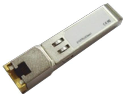
Оптический мультиплексор, 1 интерфейс E1, 1 интерфейс SFP, формфактор SFP, питание от порта SFP
