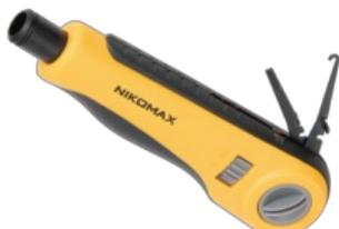
Инструмент NIKOMAX для заделки витой пары, ударного типа, 2 уровня регулировки силы удара, крепление Twist-Lock, нож для кроссов типа 110 в комплекте
