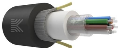
Дроп-кабель круглый, с центральной трубкой, усилен стеклонитями, 8 волокон, SM 9/125, G.657.A1, полиэтилен, 1 кН
