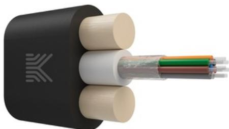
Дроп-кабель плоский, с центральной трубкой, усилен стеклопрутками, 8 волокон, SM 9/125, G.657.A1, полиэтилен, 1.5 кН
