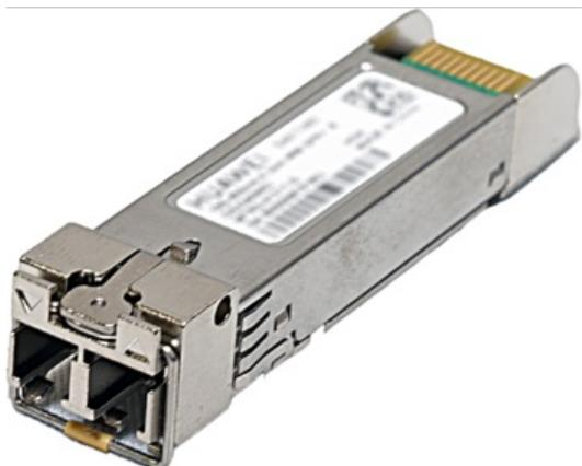
Модуль SFP+ оптический,
