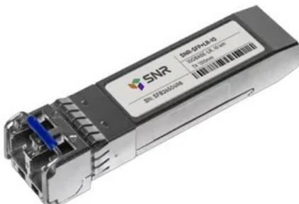
**Модуль SFP+ оптический, дальность до 10км (11dB), 1310нм, прошиты под HP**
