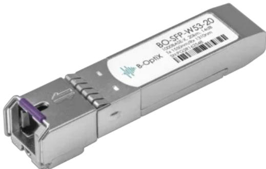
Модуль B-OptiX SFP WDM,
