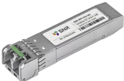
Модуль SFP CWDM оптический, дальность до 160км (41dB), 1530нм
